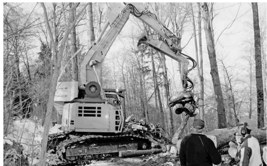
Die Maschine ist eine Kombination von einer Seilbahn, einem Prozessor und einem Bagger. Bild RoMu
